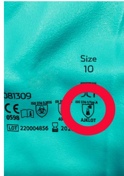
Abb. 9 Geeignete Chemikalienschutzhandschuhe beim Umgang mit Epoxidharzen
