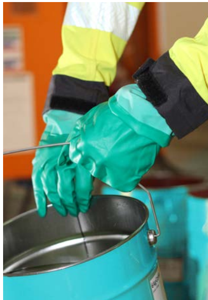
Abb. 9 Geeignete Chemikalienschutzhandschuhe beim Umgang mit Epoxidharzen
